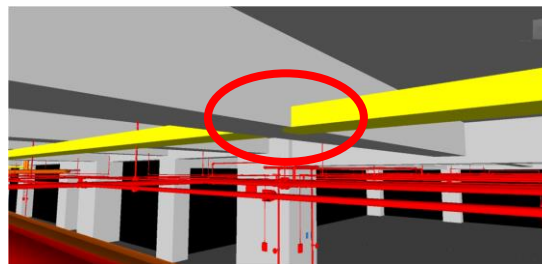
圖 8 弱電線槽與結構體衝突
