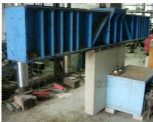
照片6 (56E)接頭試體抗剪試驗
