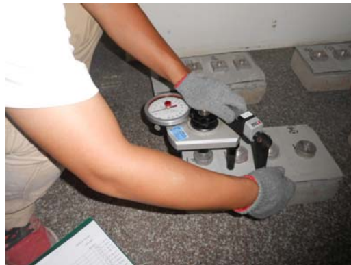
圖5 磁磚拉拔實驗
