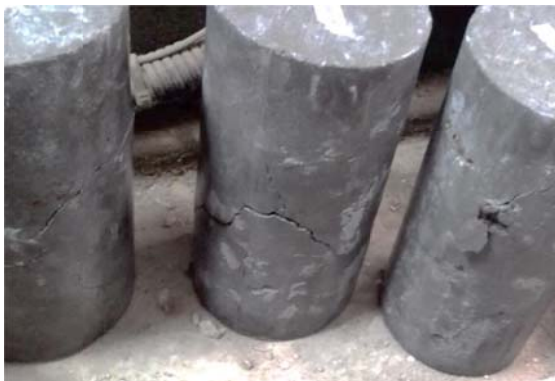
圖12 28天齡期砂漿包覆之脹裂混凝土
