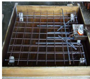
(b) (81)接頭試體鋼筋擺設
