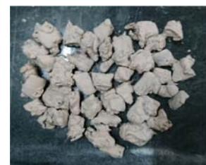
圖6 石膏包覆椰子殼輕質骨材
