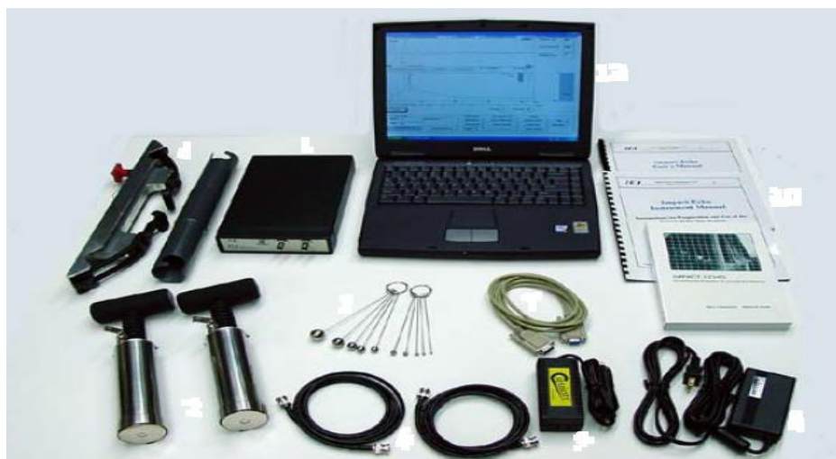
圖 3 敲擊回音法測試系統
