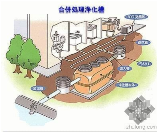
圖1 廁所設備架構 (自在建房網站)
