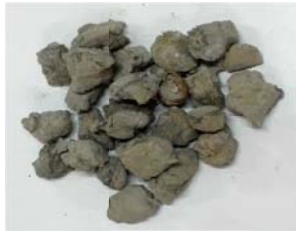
圖7 水泥砂漿包覆椰子殼輕質骨材
