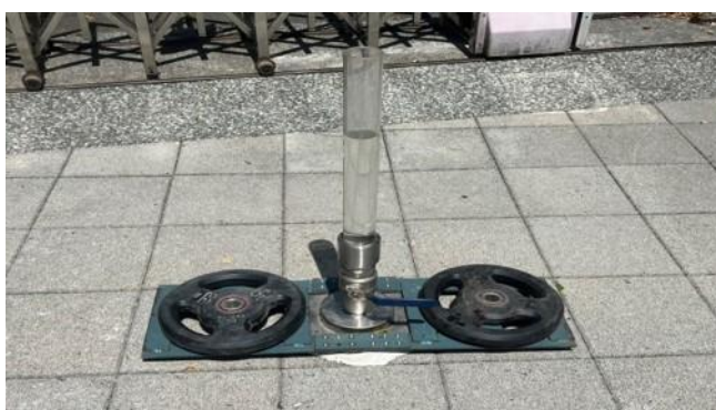
圖8 入滲試驗操作情況
