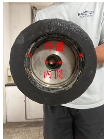
圖7 入滲試驗儀底部橡膠
