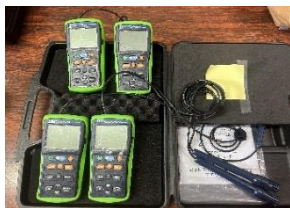
圖 1、紅外線測溫儀 用途:測量表面溫度 圖 2、箱內溫溼度量測器 用途:量測箱內溫度，使用配合軟體擷取數據 圖 3、實驗箱之示意圖(正面、反面)
