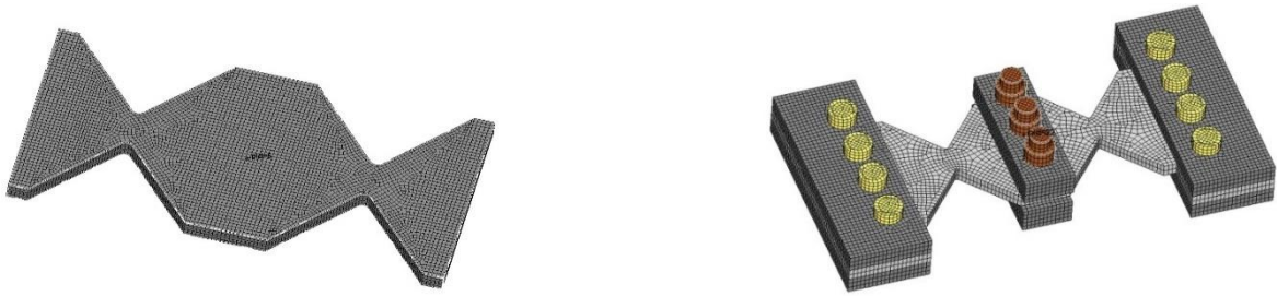
圖 3 試體數值模型：理想固定端(左)以及螺栓鎖固(右)
