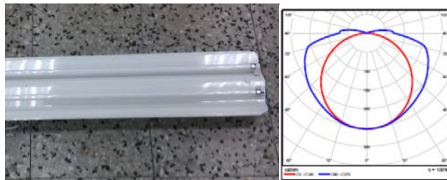
圖2. 燈具B-國內教室常用之T5燈具及實測配光曲線
