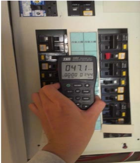
圖 1 總電箱低頻磁波測值 47.1mG 圖 2 門板內鋪低頻消磁板後測值 2mG
