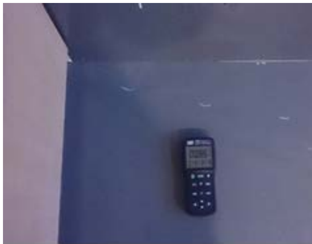
圖 3 臥房低磁波原測值為 4.89mG 圖 4 臥房屏蔽漆塗護後測值 0.86mG
