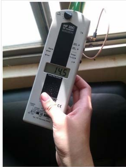
圖 5 高頻磁波原測值為 14.5 \mu\text{W}/\text{m}^2 圖 6 磁波玻璃貼護後測值 0.5 \mu\text{W}/\text{m}^2
