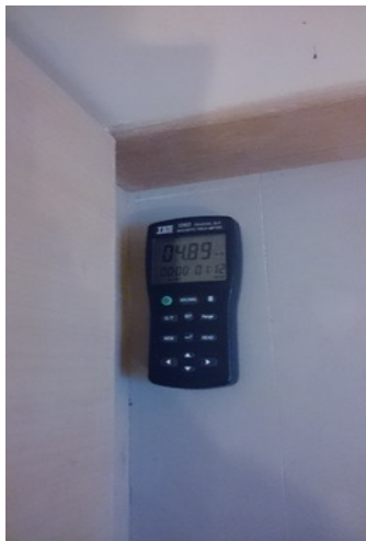
圖 3 臥房低磁波原測值為 4.89mG 圖 4 臥房屏蔽漆塗護後測值 0.86mG
