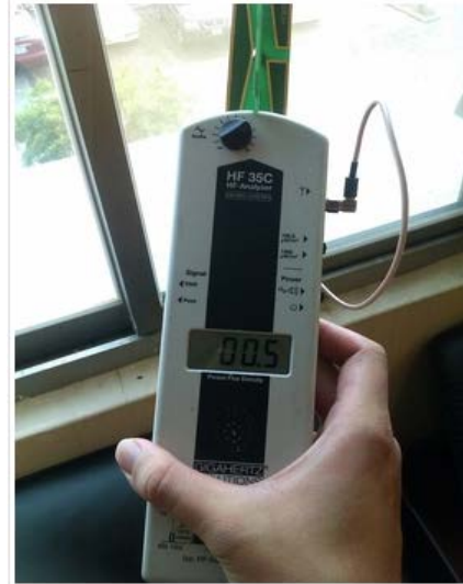
圖 5 高頻磁波原測值為 14.5 \mu\text{W}/\text{m}^2 圖 6 磁波玻璃貼護後測值 0.5 \mu\text{W}/\text{m}^2
