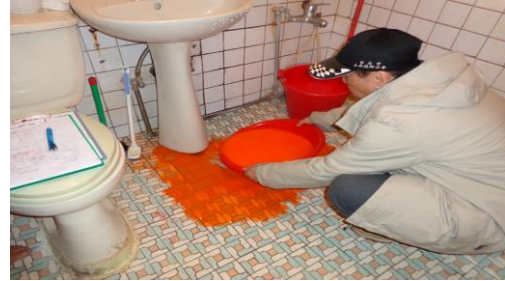
照片10 將紅色顏料水倒入排水管
