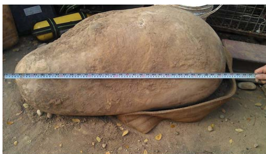
圖6、巨大卵礫石大於推進機具面盤直徑的2倍
