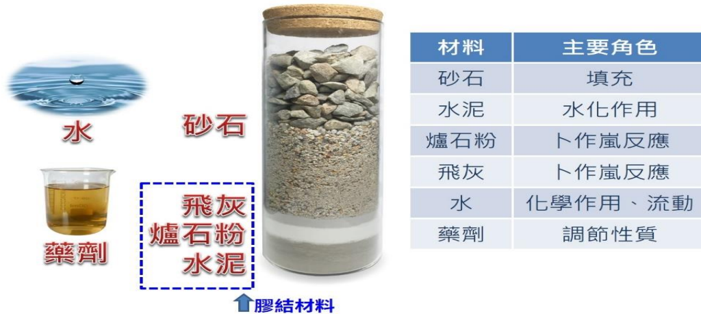
圖 1 混凝土主要組成原料及其主要功能
