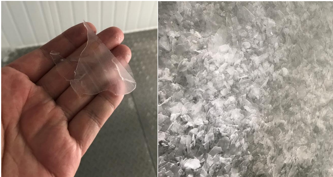
圖 12 片冰(片冰較易於混凝土拌合過程中完全融化)
