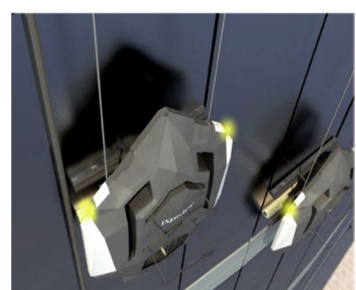
圖 16 外牆清洗機器人 (外牆專業清潔公司提供)
